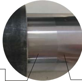
Шероховатость поверхности до обработки - Ra 1,73
