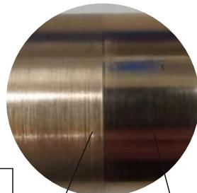
Шероховатость поверхности до обработки - Ra 1,6
