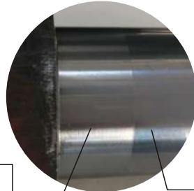
Шероховатость поверхности до обработки - Ra 1,63
