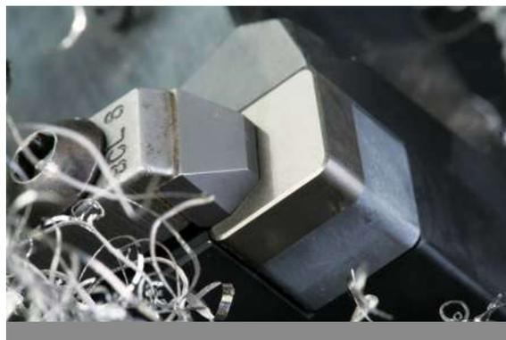
Низкая трещиностойкость керамики является причиной формирования фронта трещин, которые из-за отсутствия пластичной связующей фазы не встречают барьеров, способных затормозить или остановить их развитие. Частично проблемы относительно низкой прочности керамического инструмента решаются применением режущих керамик, армированных нитевидными кристаллами карбида кремния, нитридных керамик, керамик с покрытиями и композитных керамик, представляющих собой смесь составляющих твердого сплава и керамики.
