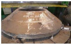
Сталь 110Г13Л (сталь Гадфильда), броня коническая твердость HRC25...35 Наружная обработка
