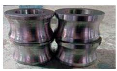
Обработка роликов Режимы резания: Vc = 100-150 м/мин f = 0,1-0,2 мм/об Ap = 0,1-0,5 мм
