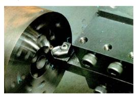
Обработка шеек, расточка, подрезка торцов шестерн Режимы резания: Vc = 130-200 м/мин f = 0,1-0,15 мм/об Ap = 0,1-0,2 мм
