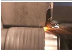
Материалы, восстановленные упрочняющими наплавленными сплавами, твердость HRC61...66
