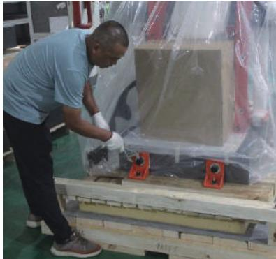
Весь процесс выглядит следующим образом: сначала открутите анкерные болты в нижней части главной машины, затем снимите пластиковую дождевую ткань снаружи.
