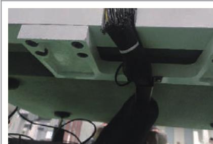
Разместите кабель измерительной машины и трубы подачи воздуха, затем закрепите его на нижней монтажной позиции с помощью крепежа, предоставленного нами.
