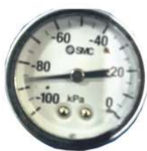
Рисунок 19. Показания вакуумметра после окончания регулировки.
