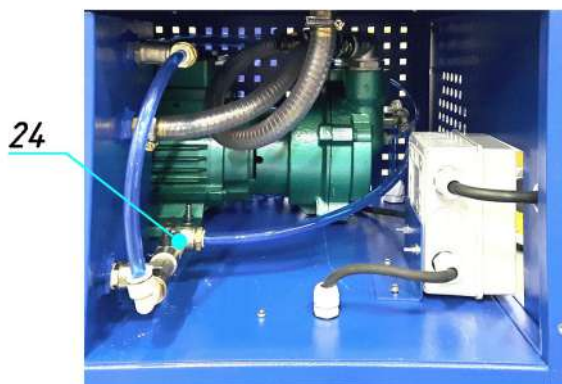
Рисунок 10. Шаровой кран первичного водяного контура затопления помпы.
