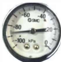
Рисунок 19. Показания вакуумметра после окончания регулировки.
