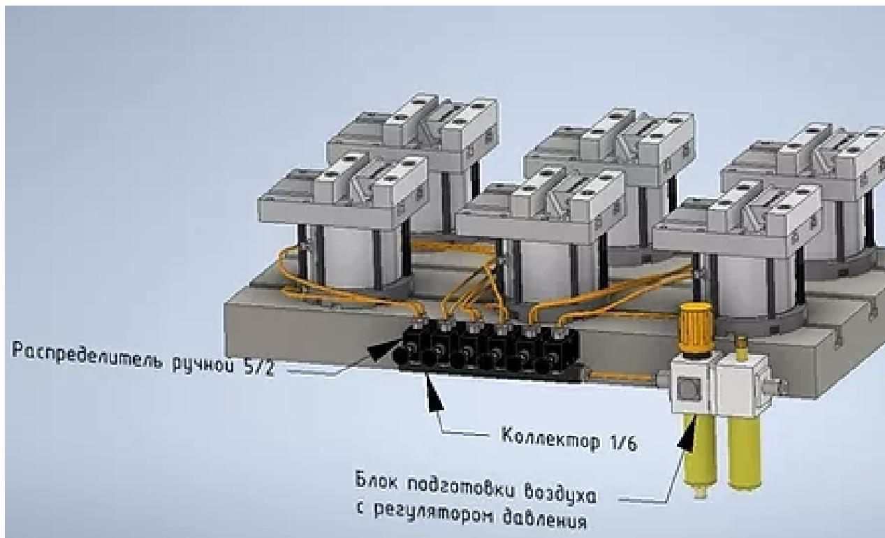
При необходимости регулировать силу давления в тисках независимо друг от друга перед каждым распределителем монтируют отдельный редуктор давления, в таком случае распределение воздуха для редукторов давления осуществляется специальный коллектор.
