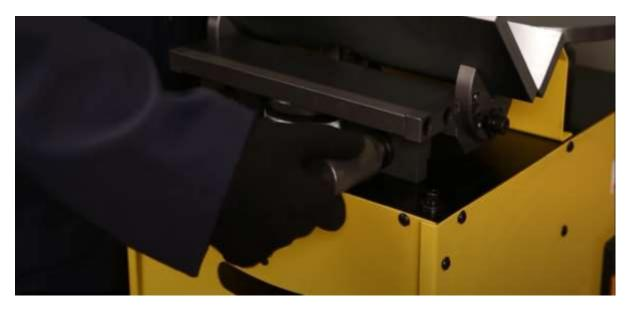
Угол наклона фаски можно изменять от 15 до 45 градусов. Для этого необходимо ослабить винты крепления поворотных секторов по одному с каждой стороны, надавить на направляющий в нужном направлении и достигнув требуемой величины, зафиксировать поворотные секторы винтами крепления.
