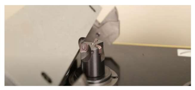
Сняв защитный кожух и узкую направляющую, получаем доступ к фрезе. Воспользовавшись ключом, можно повернуть или заменить режущие пластины.
