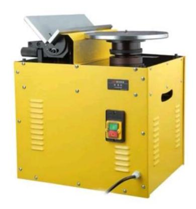
В процессе создания резьбы, обрезки труб и некоторых других видов обработки металлических заготовок, на их кромках могут образовываться заусенцы, которые создают определенные неудобства, в частности — препятствуют процессу стыковки изделий. А, кроме того, такие неровности могут нанести травму острыми кромками. По этой причине их необходимо удалять при помощи определенных инструментов, таких, как фаскосниматель-кромкорез.
