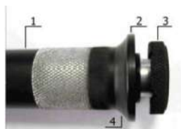
1. Корпус зонда 2. Складная насадка 3. Шайба 4. Место для пальцев
