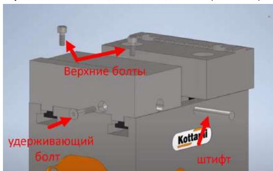
Для замены упора требуется открутить 4 верхних болта и снять упор со штифтов. Для установки, потребуется совершить те же действия в обратном порядке. Оптимальное усилие затяжки болтов упора = 120-140 Нм.
