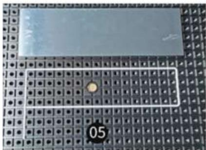
Приложите уплотнительную резиновую ленту в соответствии с размером заготовки. Поместите всасывающие отверстия внутрь уплотнительной резиновой ленты.
