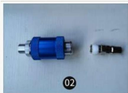
Подсоедините синий скользящий переключатель к быстроразъемному разъему с помощью водяной ленты
