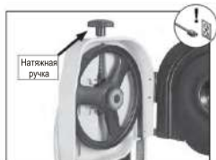
Рисунок 25. Расположение ручки натяжения.
