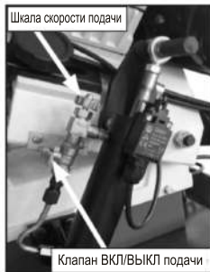
Рисунок 21. Расположение клапана ВКЛ/ВЫКЛ подачи.
