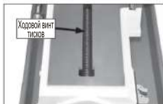
Рисунок 23. Расположение ходового винта тисков
