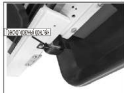
Рисунок 2. Расположение транспортировочного кронштейна.
