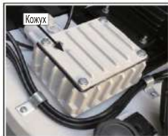
Рисунок 24. Расположение крышки коробки передач.
