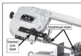
Рисунок 17. Расположение ручки направляющей лезвия.
