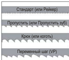
Рисунок 11. Типы зубьев полотна ленточной пилы.
