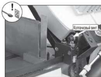
Рисунок 29. Квадрат, помещенный на столешницу напротив края лезвия.
