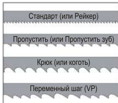
Рисунок 11. Типы зубьев полотна ленточной пилы.
