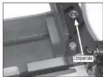
Рисунок 7. Расположение стопорной гайки.
