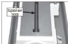
Рисунок 23. Расположение ходового винта тисков
