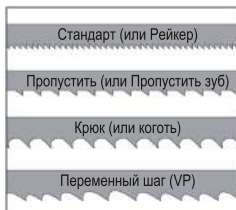
Рисунок 11. Типы зубьев полотна ленточной пилы.
