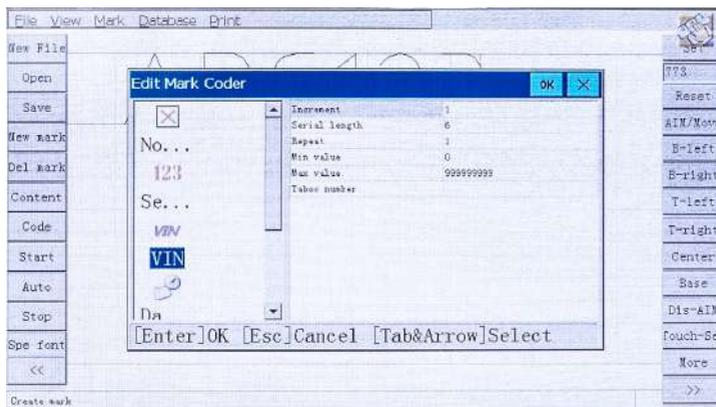
"Серийный номер/ Serial Number" имеет некоторые параметры, и здесь мы используем значения параметров по умолчанию. После завершения установки в рабочей области отобразятся два маркера. Обратите внимание, что цвет "серийного номера/ Serial Number" красный, и каждый отдельный код маркировки будет отображаться другим цветом в представлении для различения. Теперь, когда два маркера сложены вместе, необходимо скорректировать их положение. Перекрывающиеся метки выглядят следующим образом:
