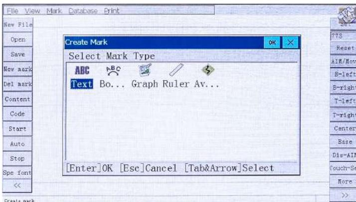
Выберите тип метки, которую нужно создать, в окне "Создать метку/ New Mark ": здесь мы выбираем метку типа "текст/ text ". А затем нажмите кнопку "OK" в правом верхнем углу окна, чтобы завершить выбор типа метки. Далее автоматически откроется окно для редактирования содержимого отметки, как показано на рисунке ниже:
