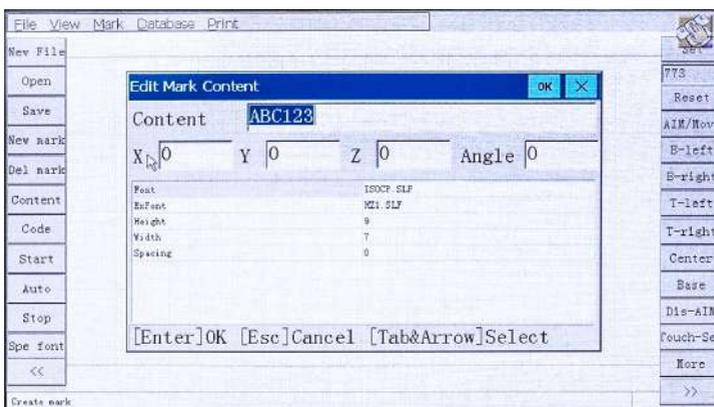
Здесь мы можем редактировать содержимое, местоположение, шрифт и т.д. знака. Нажмите на плавающее окно клавиатуры, и клавиатура всплывет, после чего вы сможете изменить содержимое пометки. Мы используем значение по умолчанию "ABC123" в качестве содержимого отметки, нажимаем "OK" в правом верхнем углу окна, чтобы завершить редактирование отмеченного содержимого, а затем автоматически откроется окно редактирования кода отметки, как показано на рисунке ниже:
