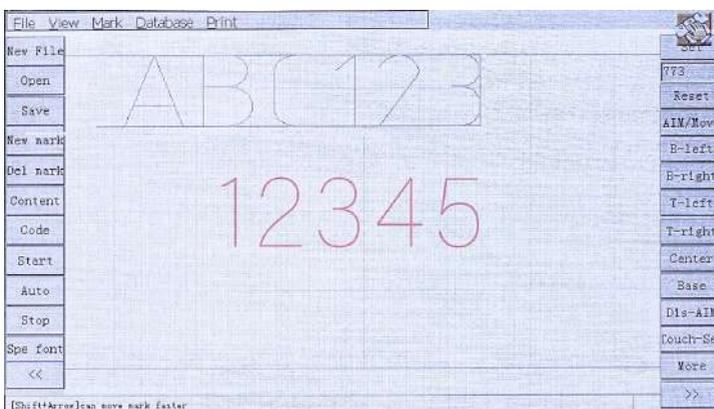
После завершения печати содержимого и настройки положения и подтверждения правильности дорожки предварительного просмотра сначала нажмите кнопку "управление воздушным потоком/air control" на электрическом блоке управления, а затем нажмите переключатель "печать/ print" на пневматической маркировочной машине или электрическом блоке управления, и пневматическая маркировка машины начнет работать. Содержимое рабочей области будет напечатано на заготовке.
